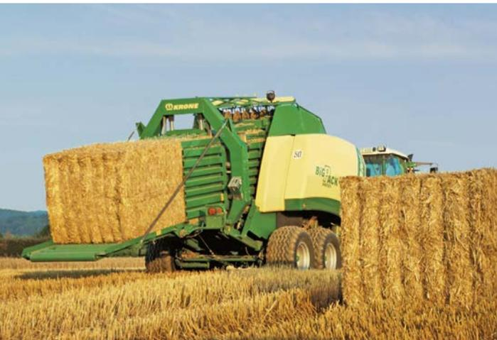
Die 2003 vorgestellte BiG Pack 12130 war damals mit einem Kanalmaß von 1,2×1,3 m das Flaggschiff unter den Großpackenpressen.
