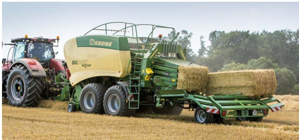
gestellten Ablagemodus werden die Ballen automatisch von einem Abschieber von der Plattform geschoben.
