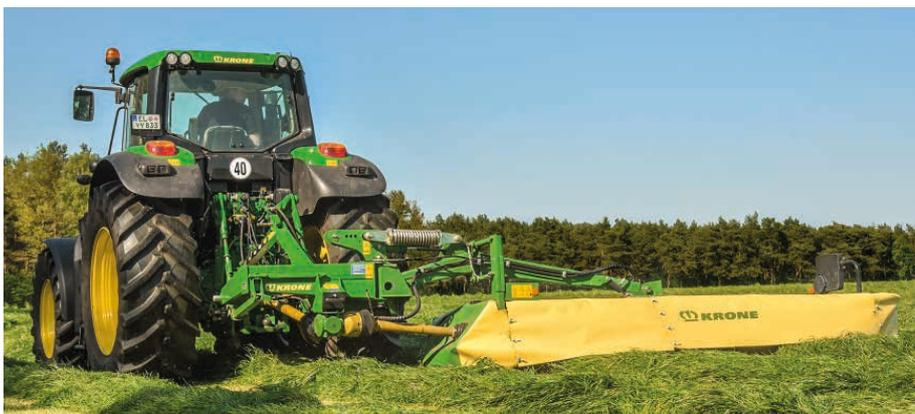
Mit dem EasyCut R 400 stellt Krone ein neues Heckscheibenmäherwerk mit 4,04 m Arbeitsbreite vor. Der robuste Anbaubock, der schnittoptimierte Mähholm SmartCut, die einzeln abgesicherten Mähscheiben SafeCut, der sichere Kollisionsschutz, die Mähholmentlastung durch Federn und die
